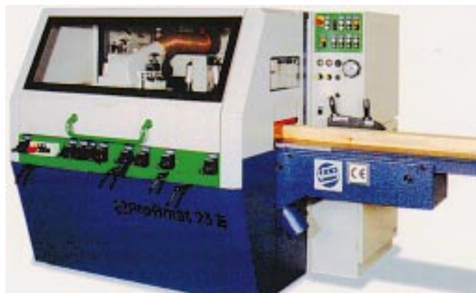
Der Profilfräsautomat „Profimat 23E“ ist 3,30 m lang und 1,50 m breit; der Abrichttisch mißt 2,0 m Länge Foto: Weinig
