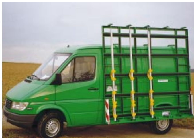
Montagefreundlich: An allen gängigen Fahrzeugtypen kann das „Supertrucks“-Glasreff befestigt werden Foto: Klemm
