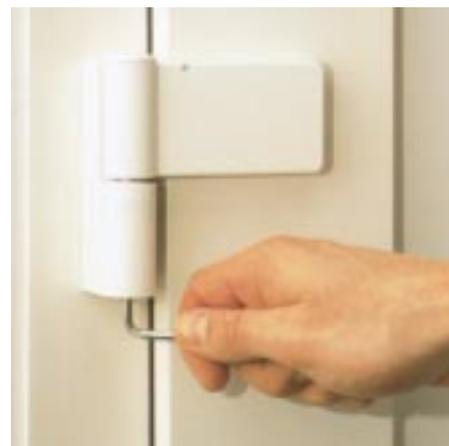
Das Türblatt kann im Handumdrehen um 5 mm angehoben, in der Tiefe um +/- 2 mm und in der Seite um +/- 5 mm verstellt werden
