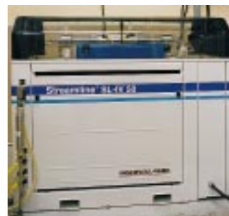
„Streamline SL IV“ erzeugt einen Hochdruck-Wasserstrahl von 3500 bar Foto: ABB I-R
