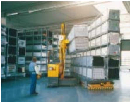
Jeweils 12 Paletten mit Fensterprofilen – Gewicht: 18 t – werden auf dem Luftkissen-Transportgerät bewegt
