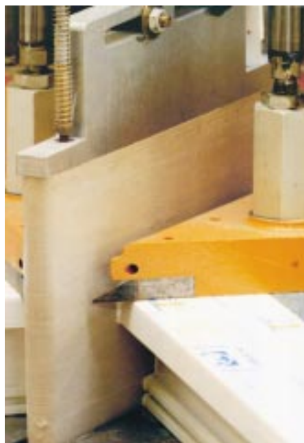
Die Teflon-Schweißfolien wurden für schwermetallfreie PVC-Profile konzipiert
