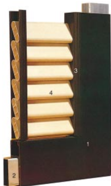
Die „Wieku“-Kunststoffklapppläden in allen RAL-Farben haben ein verschweißtes Rahmenprofil (1), einen durchgehenden Alu-Kern (2), ein auswechselbares Lamellen-Führungsprofil (3) und Kunststofflamellen mit Querstegen (4)
