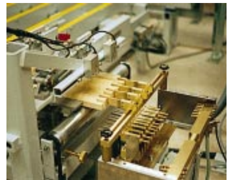
Die exakte automatische Düsenbeileimung . . .
