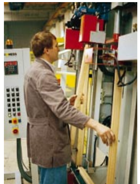
. . . und die Presse für 99 verschiedene Rahmengrößen sind die Kernstücke der Fensterbau-Fertigungslinie von Hess Fotos: Bauland
