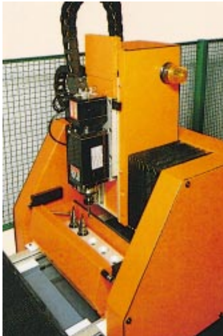
Die Werkzeugwechsel-Geschwindigkeit beträgt 15 Sekunden Foto: Tekna
