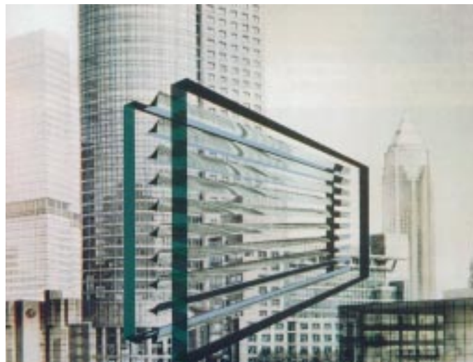
Bild 1: Schnitt durch ein Lichtlenkglas (System Köster)
