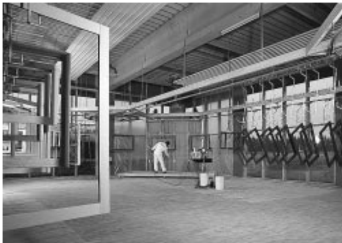
Temperiertes Spritzen im Fensterbau
