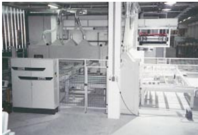
Bild 2: Vom Kassettenförderer – als einer möglichen Transporteinrichtung – gelangt das Werkstück über die Ladestation (oben rechts) zu der ersten Schleifmaschine (hinten links). Auf dem Kreuz-Hubtisch (davor) rollt das Werkstück in die zweite Schleifmaschine (Mitte rechts) und nach der Querbearbeitung auf die Ausfördereinrichtung (vorn rechts) mit der abschließenden Kontrolle
