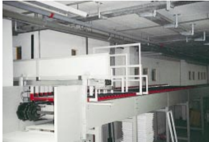
Bild 2: Vom Kassettenförderer – als einer möglichen Transporteinrichtung – gelangt das Werkstück über die Ladestation (oben rechts) zu der ersten Schleifmaschine (hinten links). Auf dem Kreuz-Hubtisch (davor) rollt das Werkstück in die zweite Schleifmaschine (Mitte rechts) und nach der Querbearbeitung auf die Ausfördereinrichtung (vorn rechts) mit der abschließenden Kontrolle
