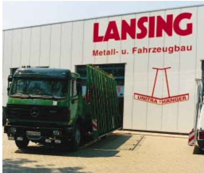
Verkürzt die Be- und Entladezeiten: Eine Lkw-Spezialpritsche mit seitlichem Schwenkreff und Ladekran Fotos: Lansing
