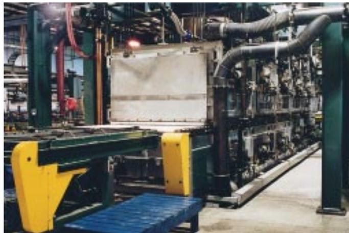
*Bild 2: Der gasbefeuerte Konvektionserhitzer für Vorspannsysteme
