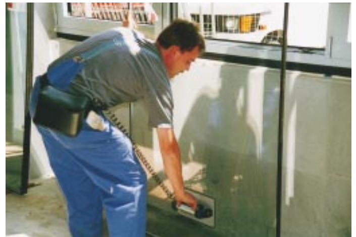
Ohne störende Zuleitungen lassen sich mit dem „Beta 50 Levistor“ Platten bis 50 kg Gewicht heben Foto: Wimag
