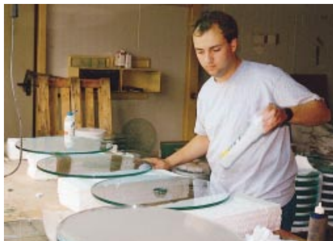
Unsichtbare UV-Verklebung von Glas mit Glas, Metall, Marmor oder Holz
