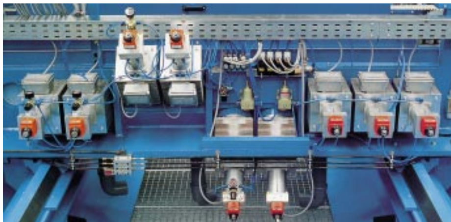
Hochleistungs-Schleifspindeln mit Verschiebeanker befinden sich an allen Schleifmaschinen
