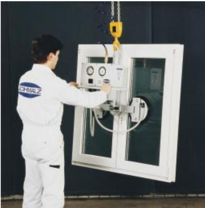
Stabilen Unterdruck durch Strömungsventile bietet das Bohlenhebergerät „Vacumaster VHB“ Foto: Schmalz
