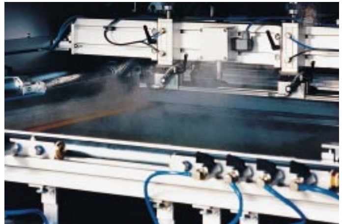
Bild 2: Durch Ultraschall erzeugter Nebel Fotos: Thieme
