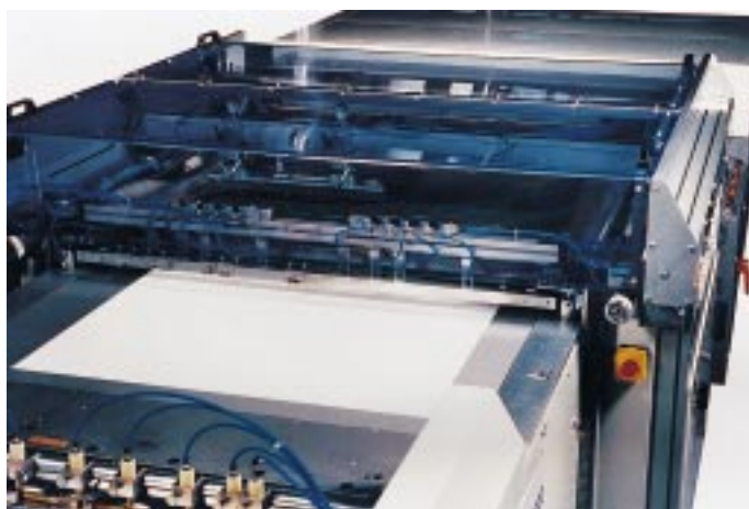
Bild 1: Vollautomatisch gesteuertes Luftbefeuchtungssystem zum Druck mit wasserbasierten und lösemittelhaltigen Siebdruckfarben mit der Klarsicht-Abdeckhaube
