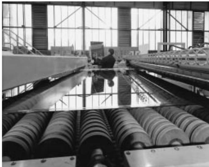
*Fortschritt in der Spiegeltechnologie: Die Silberschicht kann jetzt im On-line-Verfahren aufgebracht werden*
