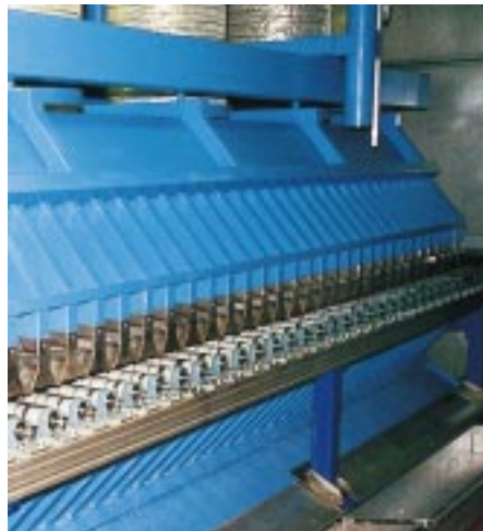
Die „Quentsch“, in der die Scheiben durch exakte Kühlung die notwendige Vorspannung erhalten
