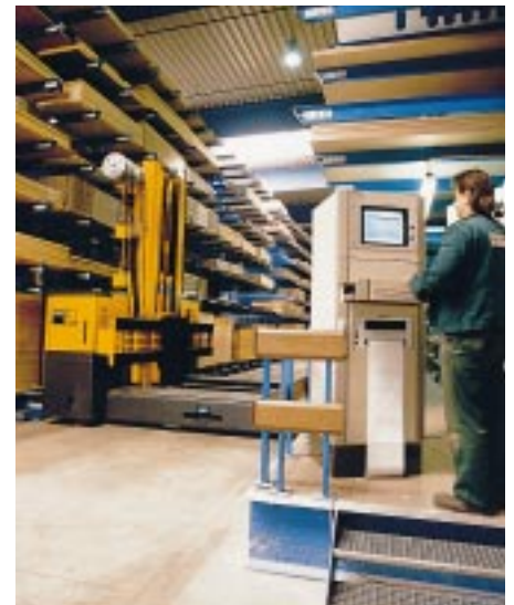
Elektro-Vierwegestapler sorgen für waren- und termingerechte Belieferung
