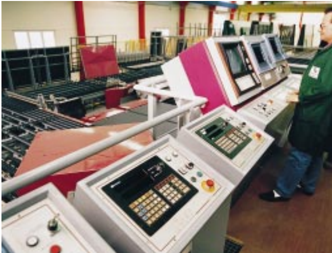
Im „Glasbahnhof“ werden Glaszuschnitt und Glaszuführung auf die Anlagen automatisch gesteuert
