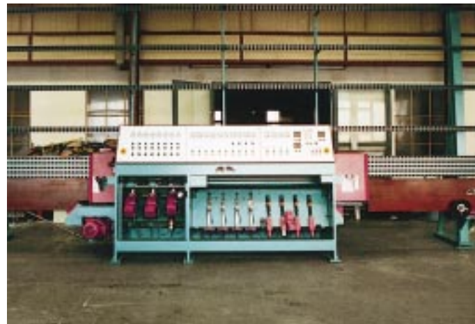
Der Glaskanten-Schleifautomat „K 414 GE“ nach der Fertigstellung im Celler Werk
