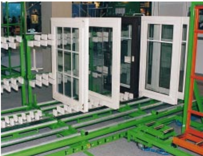
Die Fenster-Fächerpalette „FFP 9“: Das exakte Positioniersystem ermöglicht ein sicheres und schnelles Einschieben des Fensters in das gewünschte Fach
