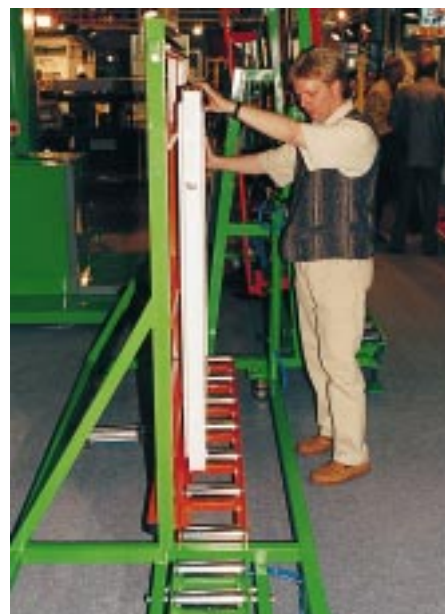
Mit dem Shuttlewagen wird das fertig verglaste Fenster zum ausgewählten Fach der Fächerpalette transportiert, positioniert und eingeschoben
