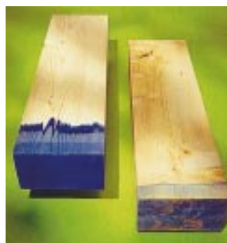
Der Tintentest beweist: Anders als herkömmliche Grundierungen verhindert „Rustikal Concept Grund“ das Eindringen flüssiger Substanzen besonders effektiv Foto: Sigma
