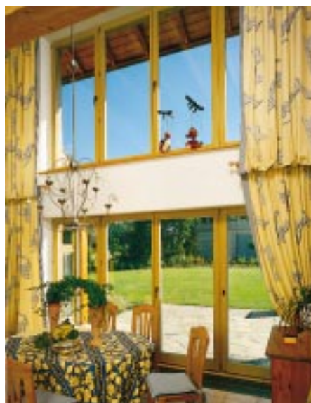
Holz-Alu-Fenster schaffen Behaglichkeit im Innenbereich, während das Aluminium im Außenbereich sich durch Witterungsbeständigkeit und Pflegeleichtigkeit auszeichnet
