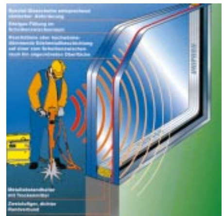
Lärmschutz durch asymmetrischen Scheibenaufbau Zeichnung: Uniglas
