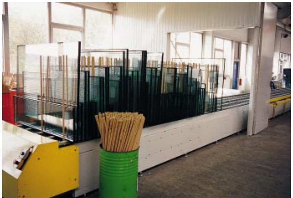
Bild 1: Vollautomatisch erfolgen der Glaszuschnitt und die Zulieferung der zugeschnittenen Scheiben auf die Lenhardt-Fertigungsstraße
