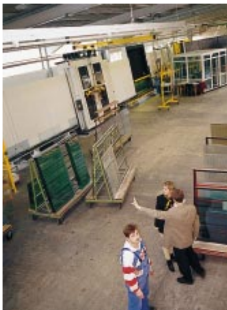
Bild 2: Vom Aushärteigel werden die Isolierglasscheiben kommissionsgerecht ausgeliefert
