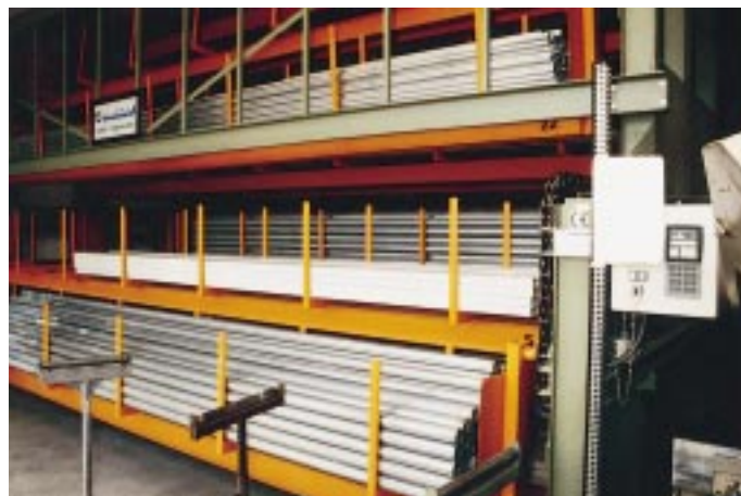
Bild 3: Eingabe- und Entnahmestation des Umlaufregals, in dem vorwiegend Stahlprofile eingelagert sind
