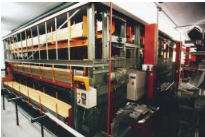
Bild 2: Entnahmestation des mit Aluminium-Profilstangen bestückten Umlaufregals
