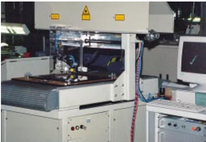
Laserstrahl-Glasschneideanlage bei Desag
