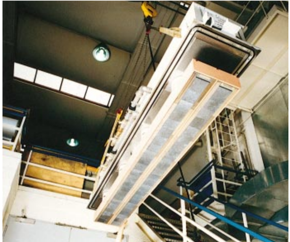
Das neue Beschichtungsmodul „TwinMag“ Fotos: Leybold Systems
