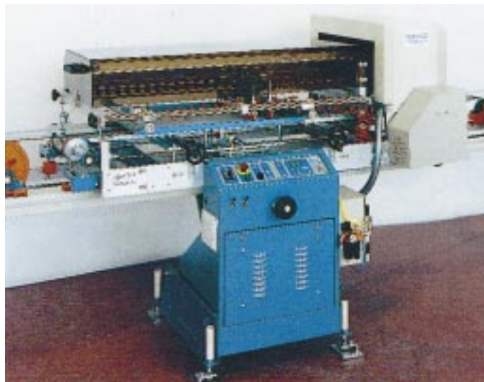
Siebdruckmaschine „Deco-Glass“ Foto: Keraglass
