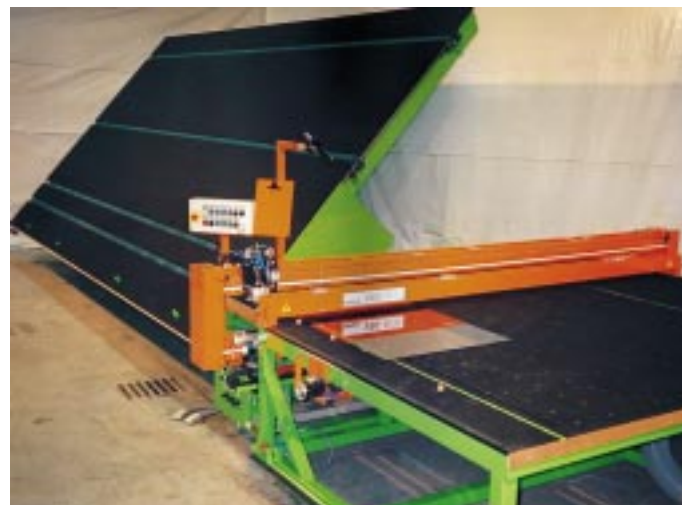
Verbundglas-Schneidanlage „M 33“ mit vorgelegtem Luftkissen-Riemensystem Foto: Hegla
