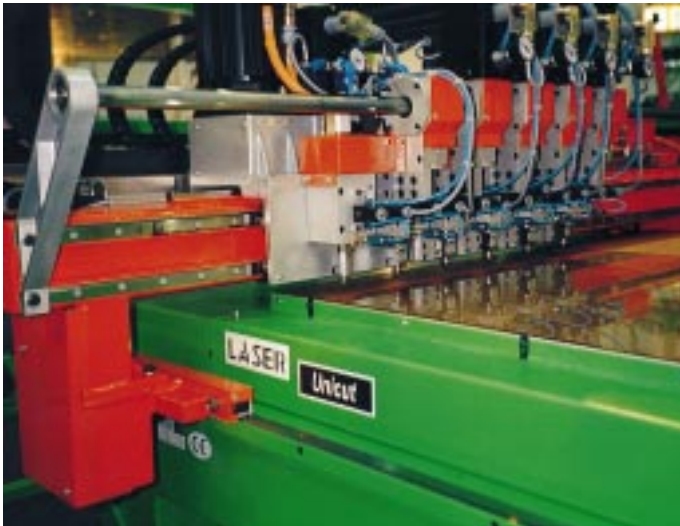
CNC-gesteuerte Mehrkopfschneidmaschine „Unicut“ Foto: Laser
