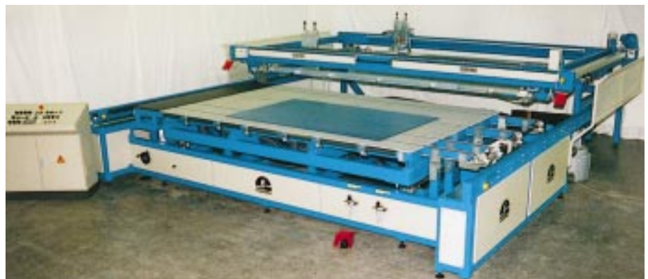
Bild 5: Siebdruckmaschine Typ SH: 3/4-Automat mit Transportriemen und Saug-/Blaslufteinrichtung für Glasbedruckung von rechteckigen Scheiben und Formscheiben Foto und Zeichnungen: Fleischle
