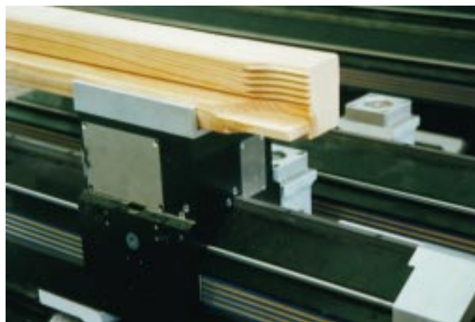
Fenstereinzelfertigung: Rahmen-teil mit CNC-Eckverbindung „Genius“, aufgespannt auf CAN-Saugern, selbst-fahrend und programmierbar
