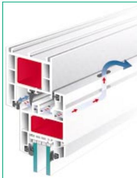
Roplasto Basislüftungssystem (flächenversetzt) *Grafik: Roplasto*
