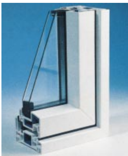
„Clou“, das Fensterprofil mit fünf Kam-mern und anextrudierter Dichtung
