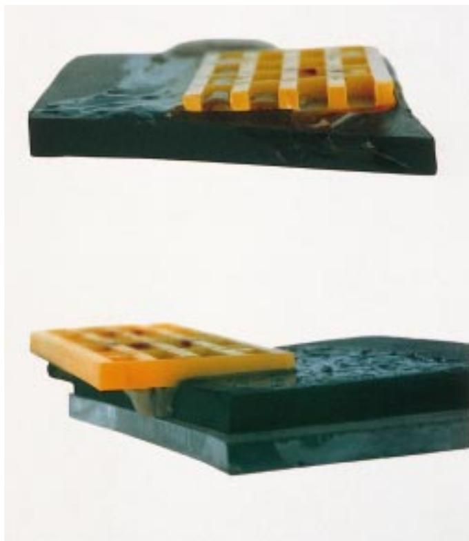
Das Foto zeigt einen Klotz aus einem Prüfversuch – Klotz und Randverbund wurden durch Weichmacherwanderung zerstört
