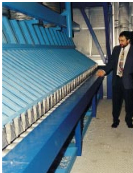
Dipl.-Ing. Guido Becker bei der Optimierung eines Hochkonvektionsofens; sorgfältig wird jeder Parameter überprüft; hier die Quench
