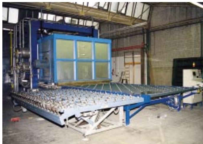
Blick auf einen gasbeheizten Hochkonvektionsofen, der Scheiben bis zu den Maximalabmessungen von 2,4 m x 5,5 m in einwandfreier Qualität vorspannen kann
