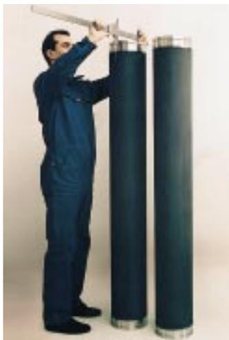
Rohrtargets für die Dünnschichttechnik Foto: FNE
