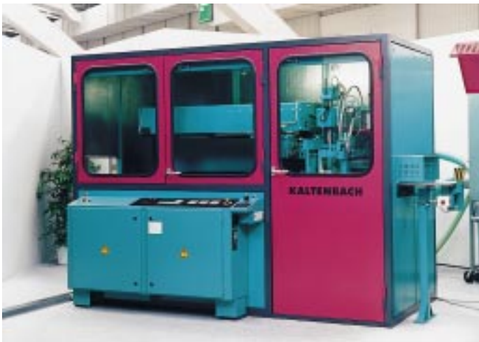
NC-gesteuerter Hochleistungssägeautomat „RKL 551 AX“ Foto: Kaltenbach
