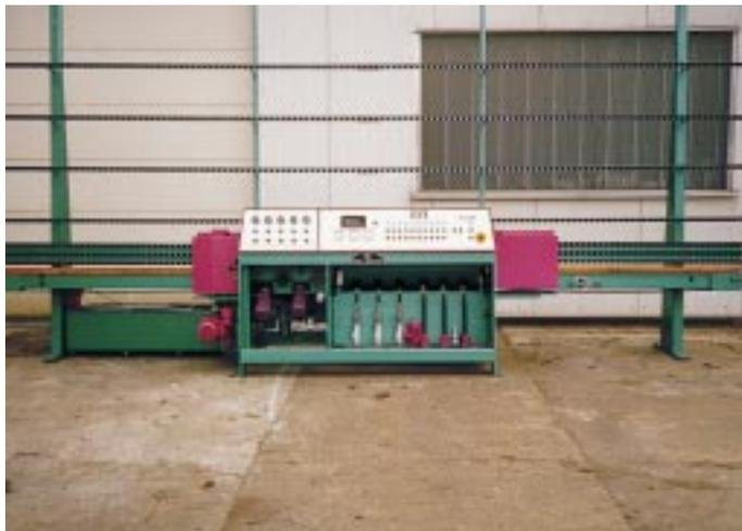
VSG, aber natürlich auch bei normalem Floatglas, speziell bei Gehrungekantenschliff, aber auch Flachkantenschliff mit Saum. Auf Kundenwunsch können zwei verschiedene Konzepte geordert werden und zwar die Standardvariante, die auf der Glasotec zu sehen sein wird, für Glasstärken von 2 bis zu 30 mm oder eine spezielle Variante für Stärken von 4 bis zu 42 mm und Stückgewichten bis zu 750 kg.
