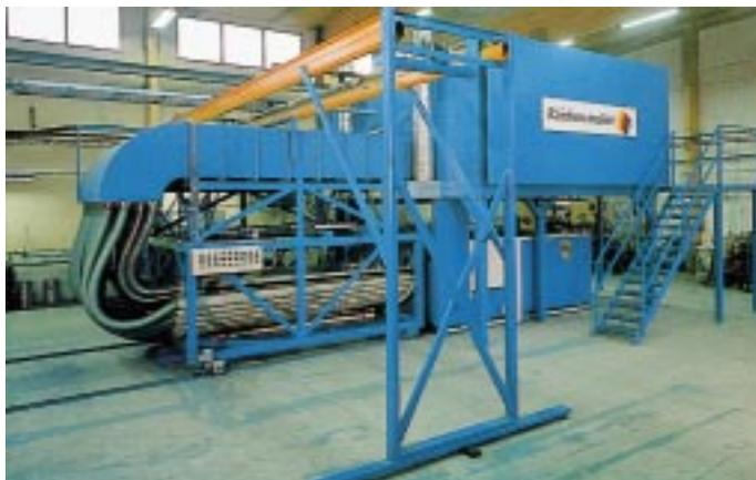
Beide Biegeöfen sind mit der „Fuzzy-Bend-Steuerung“ für ein optimales Biegeergebnis ausgerüstet und verfügen über vertikal regelbare Falzerwärmungselemente zur effizienten Wärmeübertragung. Die jeweiligen Betriebszustände werden über Modem durch Ferndiagnosesysteme überwacht und nachgeführt.
