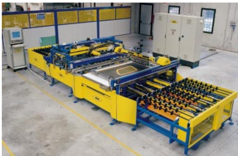
*Scheibendruckanlage „GHS 38-T“ von AISA S.p.A.*
