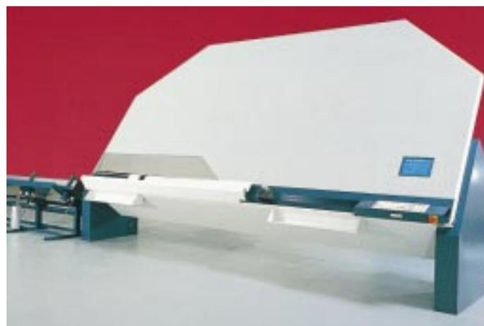
Für Unternehmen mit einer Fertigung bis 1000 Rahmen/Schicht konzipiert – die „Masterbend MB 450“
