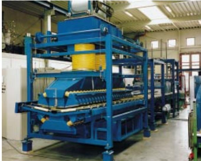
*Schwerkraftbiegeanlage für zylindrische Scheiben*
