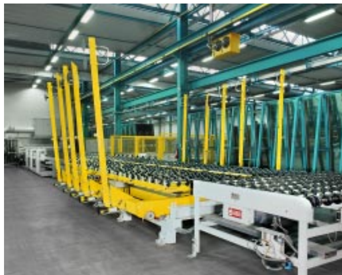
Beidseitiger Untertischstapler Foto: Hager Maschinenbau
