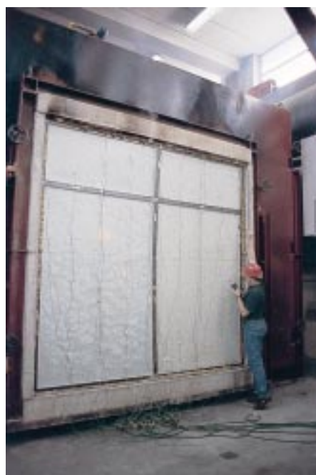
Erfolgreiche Bauteilprüfung mit den beiden F30-Gläsern „Contraflam“ (r.) und „Swissflam“ (l.)
