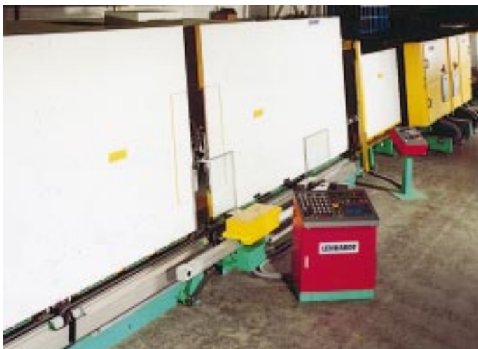
Die vertikale Hochleistungs-Isolierglas-Fertigungslinie mit Tandem-Gasfüll- und Preßautomat – gleichzeitig werden zwei Isolierglas-Einheiten unterschiedlicher Abmessung zusammengebaut, mit Gas befüllt und verpreßt
