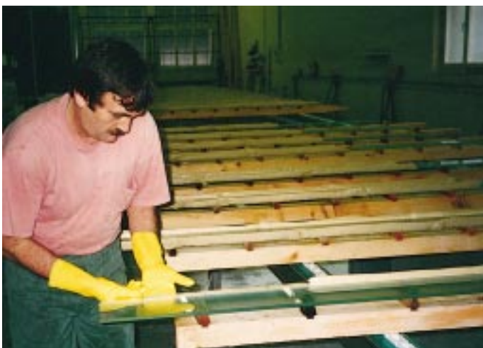
Sorgfältiges Abnehmen der 100 % recycelbaren Dichtung nach dem Ätzvorgang
