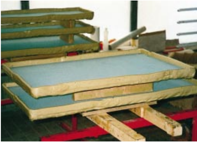
Mit einer säure-resistenten Dichtungsmasse wird das Glas zu einer Auffangwanne präpariert
