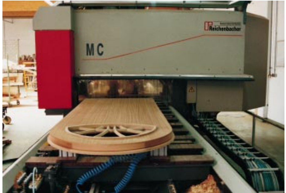
Das „RANC MC“ Bearbeitungszentrum für die Fertigung von Fenster und Türen
