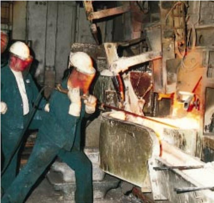
*Ist der Schmelzvorgang abgeschlossen, wird der Ofen „angestochen“ und das flüssige Leichtmetall fließt in Rinnen zu den Formen für die Preßbolzen*
