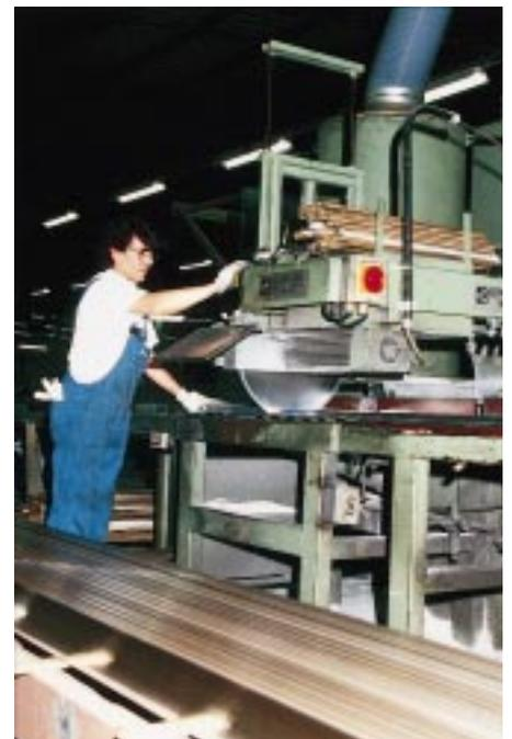
*Nach dem Preßvorgang werden die Profile, aus denen später Fenster, Türen oder Fassaden entstehen, auf eine Lager-Länge von 6,4 m abgelängt*
