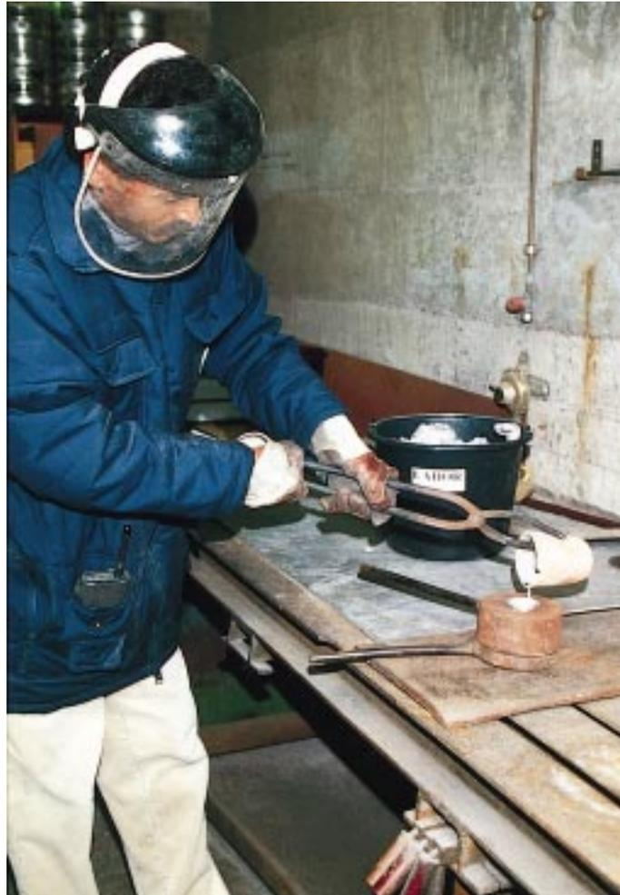
*In einem speziellen Ofen werden die Proben eingeschmolzen und anschließend analysiert*
