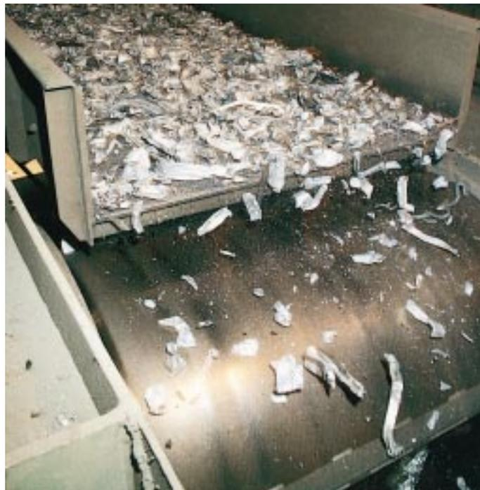
Mit Hilfe eines Wirbelstrom-Abseiders wird Aluminium von Fremdanteilen getrennt
