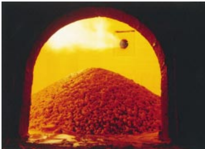
Hafenofen mit Oxy-Fuel-Brenner zur Herstellung von Bleikristall Bild: Linde
