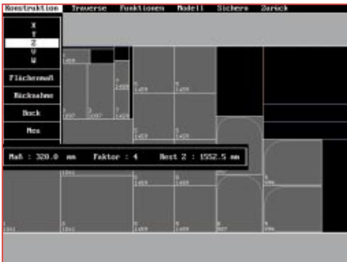
Bild 3: Schnittplandarstellung der Software „Edicut“ von Hanic
