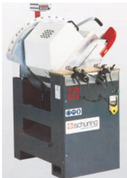
nung des Maschinenschwerpunkts in der Kopf-Drehachse. Der pneumatische Spannzylinder und der optionale Anschluß an eine Absauganlage erhöhen Arbeitskomfort und -sicherheit.
