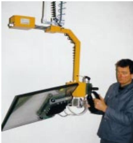
Im Produktionsablauf muß eine Vielzahl von Scheibenformaten und Glasdicken von Isolierglasscheiben umgesetzt und achsverändert abgestellt werden. Beim Transportsystem „PM 0105/89“ ist über Handrad ein Drehwinkel von bis zu 340° einstellbar. Falls notwendig, kann auch eine Winkelbegrenzung voreingestellt wer-
