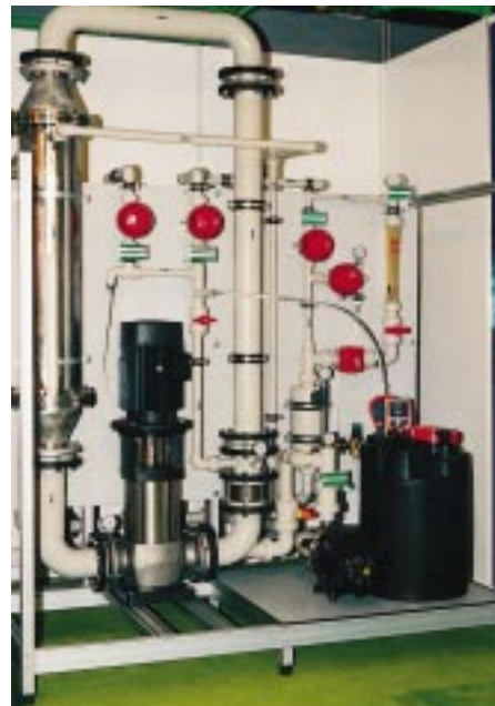
Messeaufbau einer Wasseraufbereitung mit Filter und Ionentauscher
