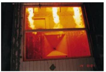
Ein selbstklebendes Fugenband aus faserfreiem Material entwickelt im Brandfall einen hitzeisolierenden Carbonschaum, der die Ausbreitung von Feuer und Rauch erheblich verzögert
