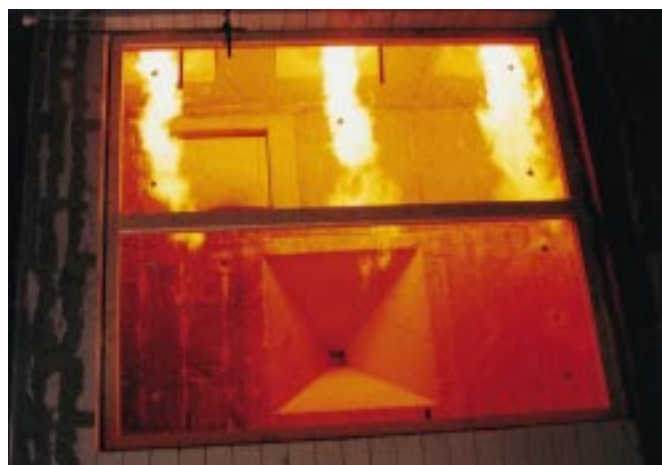
Das Brandschutzglas „Pyranova“ im Hitzetest.
